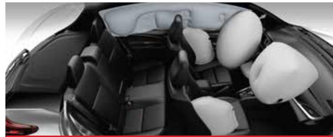
Airbags frontales (conductor y acompañante), laterales (x2), de cortina (x2) y de rodilla (para conductor).<sup>(3)</sup>
