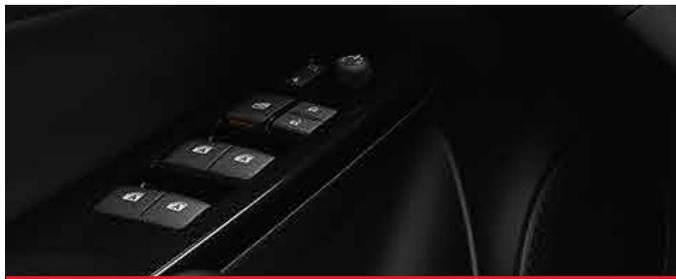
Levanta cristales eléctricos con función "One Touch" en las cuatro puertas.<sup>(2)</sup>
