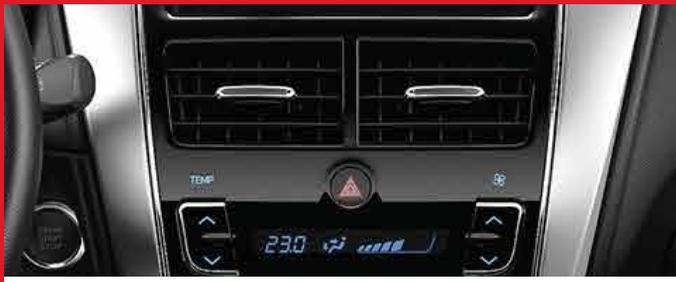
Aire acondicionado con climatizador automático digital.<sup>(1)</sup>
